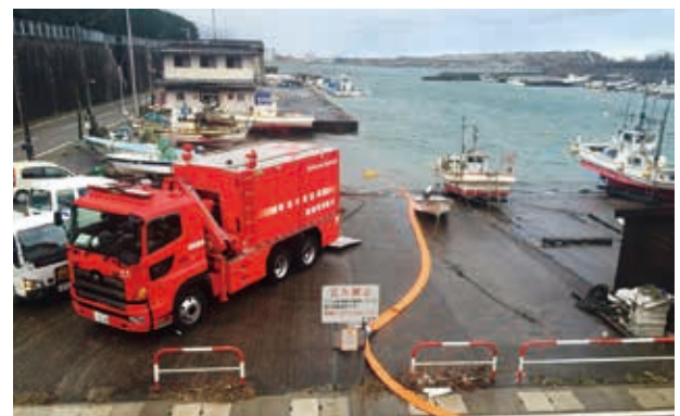
海水利用型消防水利システム車(撮影:新潟市消防局)
